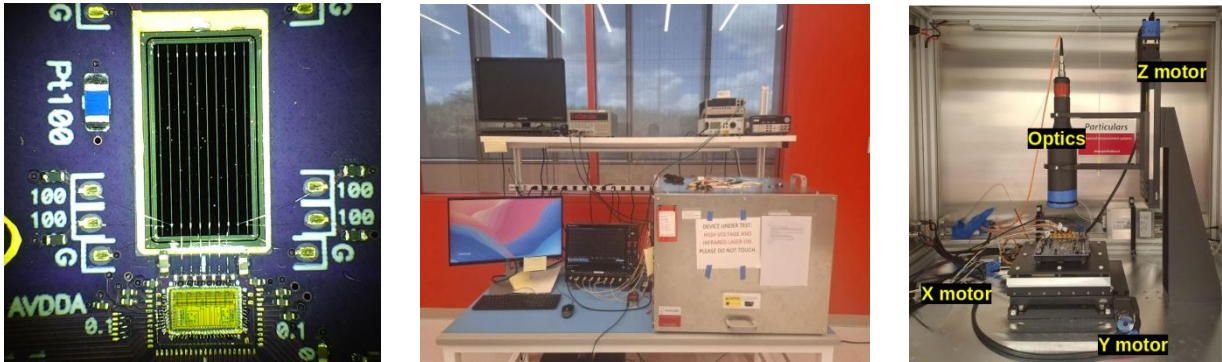
Նկար 1. FCFD չիպը (ձախից) և թեստավորման համակարգը:
