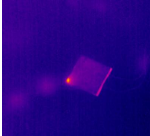
Նկ. 9. Էլեկտրական հոսանքով տաքացված ITO/ապակի հարթակին նստեցված թաղանթի ջերմատեսիլային պատկերը:
