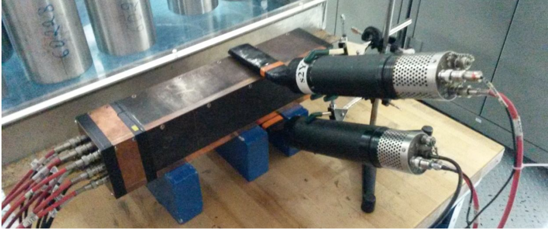
Նկար 3. NPS-ի նախատիպը կոսմիկական ճառագայթներով փորձարկման ժամանակ: Նախատիպից վերև և ստորև տեղակայված սցինտիլյացիոն հաշվիչները ծառայել են որպես տրիգեր:
